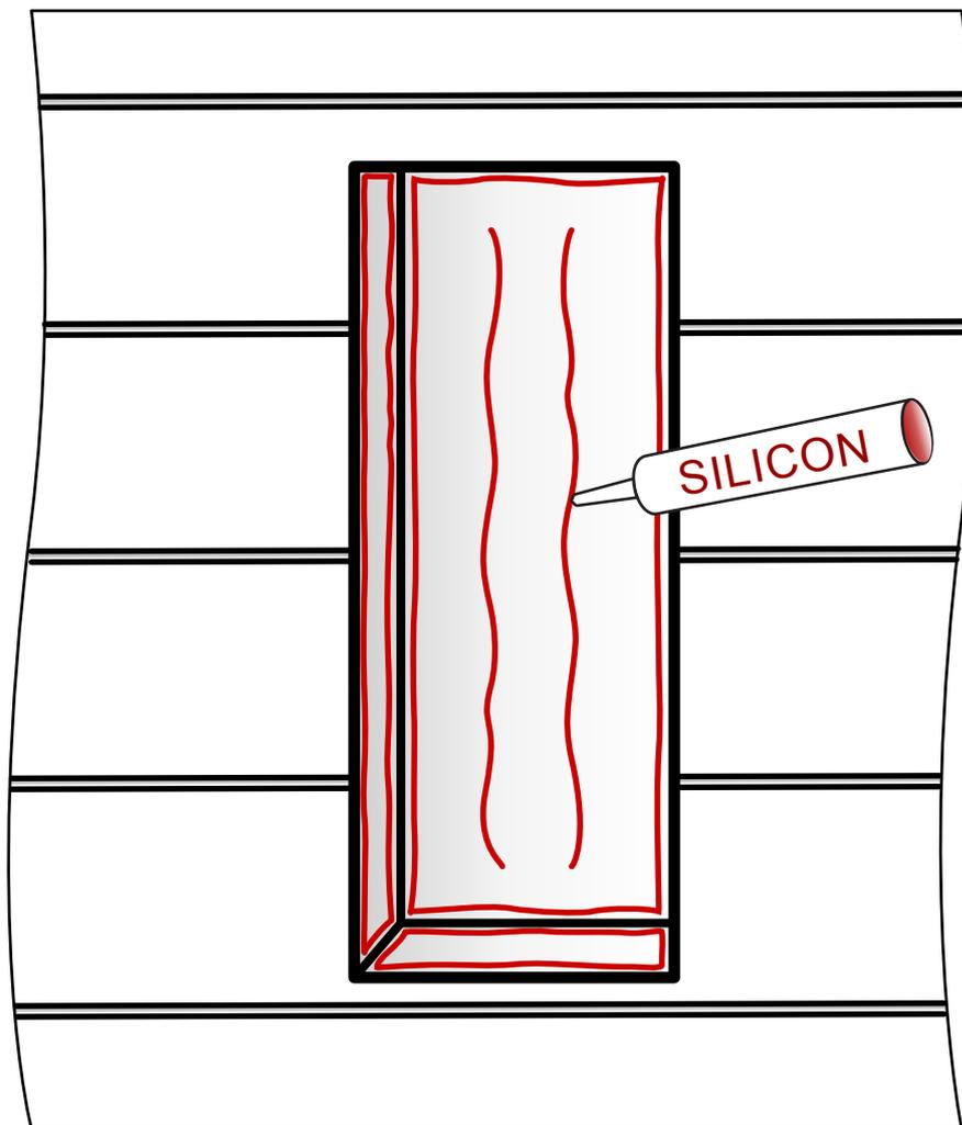
**DE** - Für die Montage der inup Brandschutz-Set «Fire Guard», verwenden Sie ausschließlich Hochtemperatur Silikon ab mind. 600°C Temperaturbeständigkeit. Bitte tragen Sie das Silikon seitlich entlang für das Band und auf der Rückseite für die Matte wie abgebildet auf.
