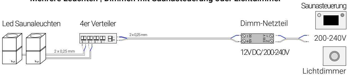
Bild 9 Mehrere Leuchten | Dimmen mit Funk-Lichtdimmer BASIC
