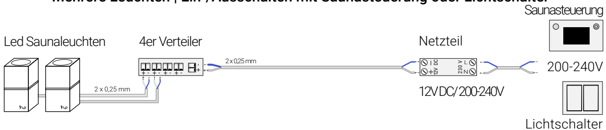
Bild 8 Mehrere Leuchten | Dimmen mit Saunasteuerung oder Lichtdimmer
